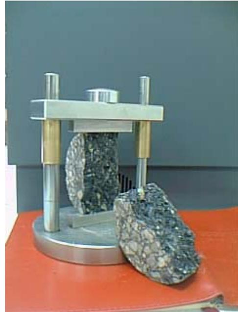
La imagen de la izquierda muestra la posición del espécimen en la prensa Lottman. La imagen de la derecha muestra la fractura de la probeta después del ensayo.
