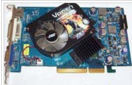
Tarjeta gráfica nVIDIA NV43 AGP (Geforce 6600GT) con disipación del calor por ventilador
