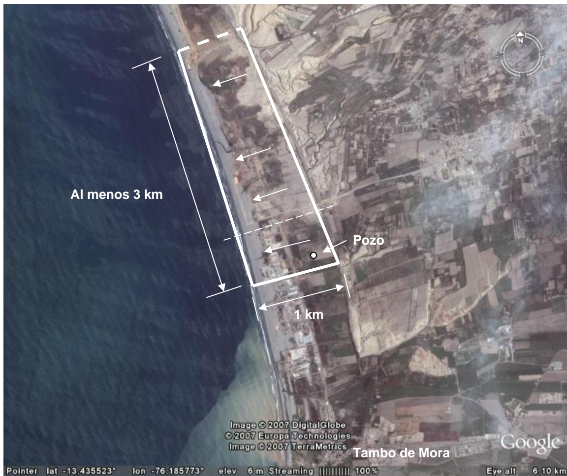
Figura 17: Desplazamiento lateral del terreno asociado a licuación en Canchamaná. Mapa base cortesía de Google Earth.
