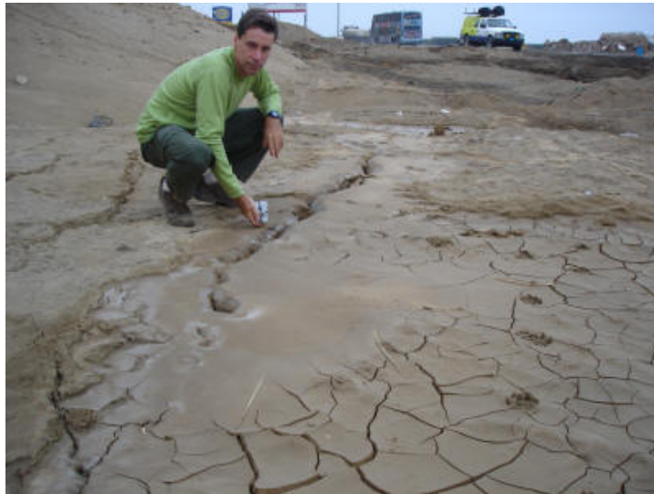
Figura 15: Gran cono de arena con finos posiblemente licuados.
