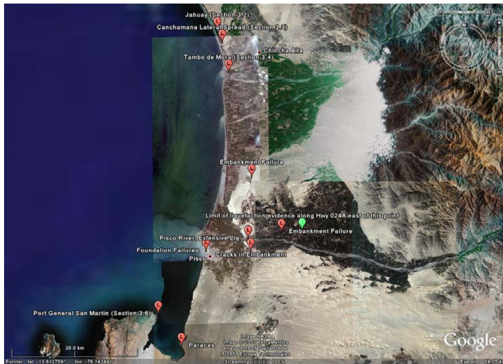
Figura 12: Acercamiento de la zona de Pisco y sus evidencias de licuación. Mapa base cortesía de Google Earth.
