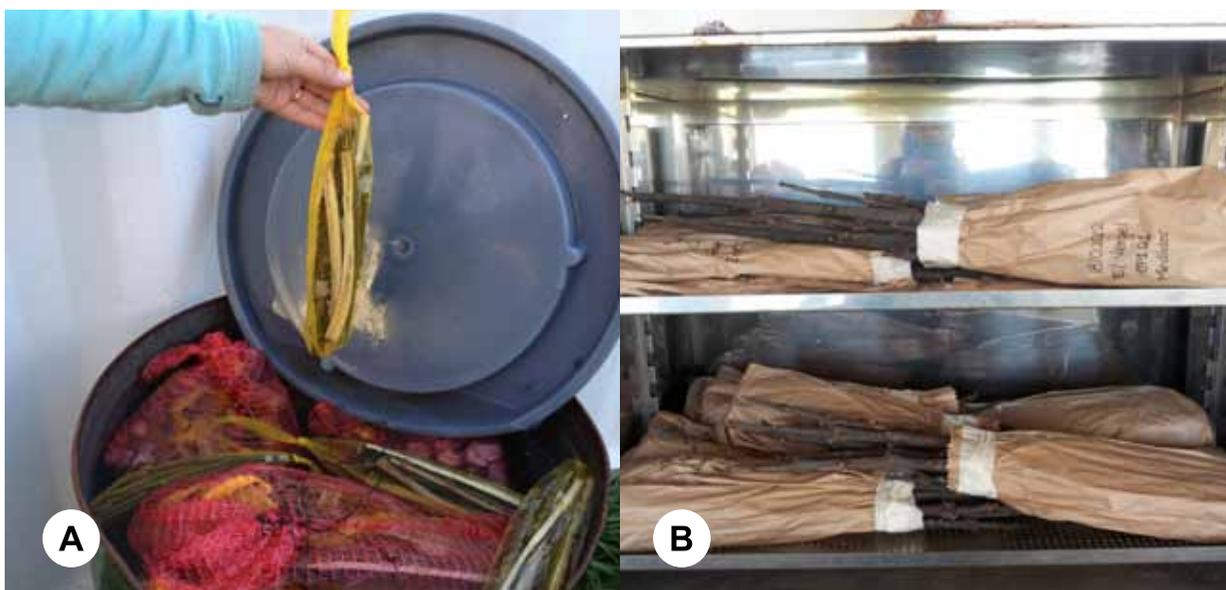
Figura 41. Determinaciones de variables de la biomasa de *P. elongata x fortunei*. A) Determinación de densidad. B) Secado de la biomasa.
