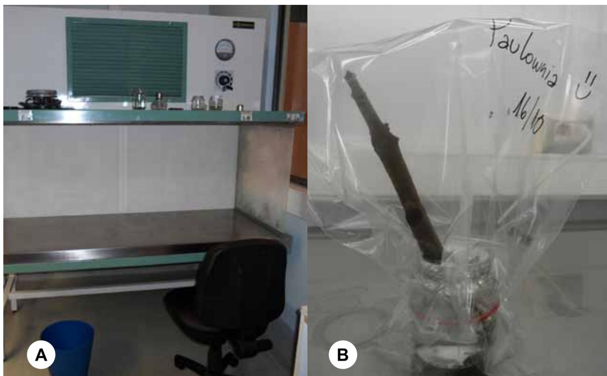
Figura 23. Procedimiento de asepsia. A) Cámara flujo laminar. B) Vareta después de la primera asepsia para llevar a incubación de material in vitro, Centro de Biotecnología de la Universidad de Concepción.
