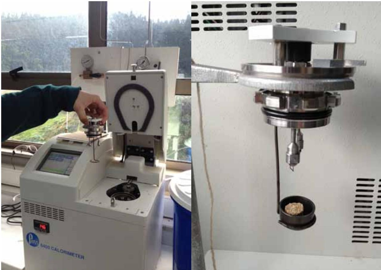
Figura 45. Bomba calorimétrica, modelo PARR 6400, utilizada para la determinación de poder calorífico.
