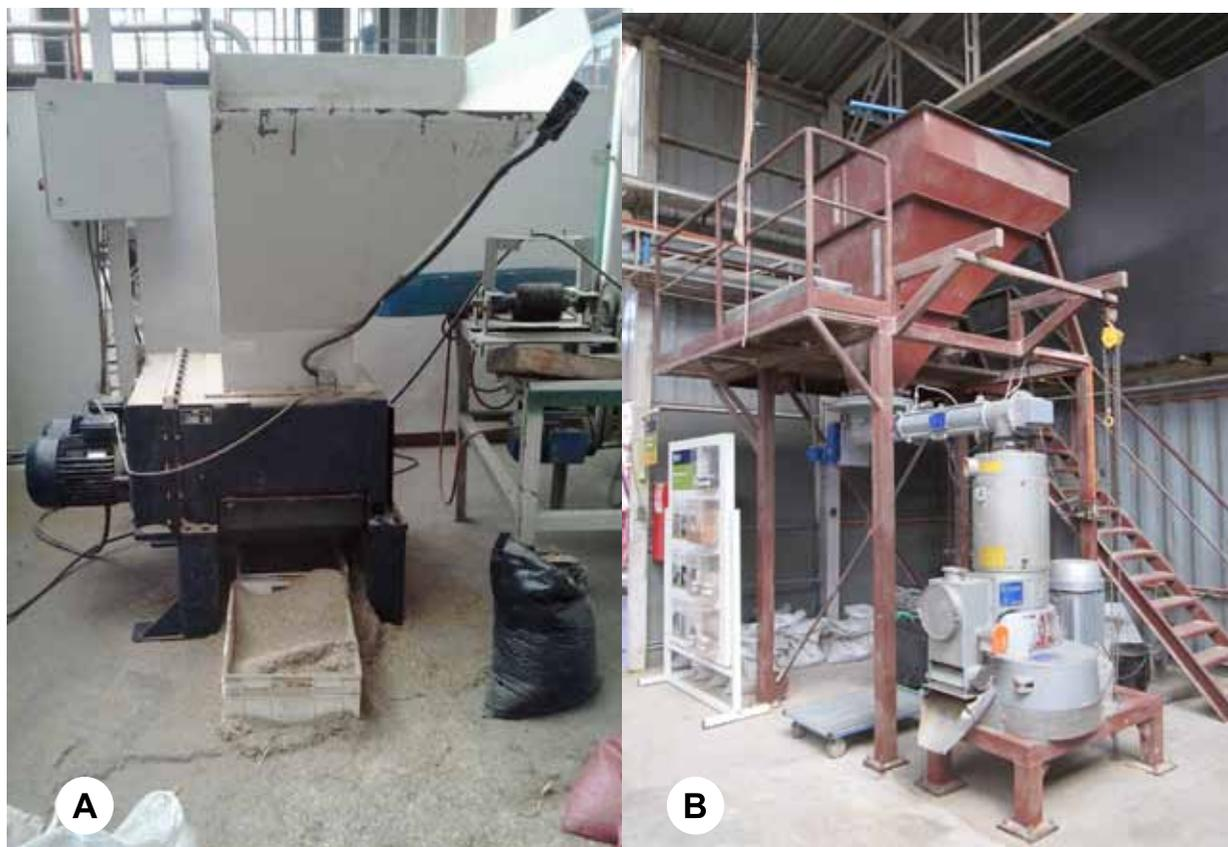
Figura 48. A) Máquina de molienda y B) máquina peletizadora, Unidad de Desarrollo Tecnológico (UDT) de la Universidad de Concepción.
