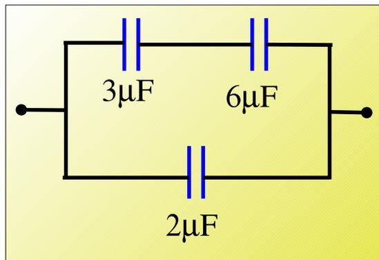
Figura 1: Circuito de condensadores
