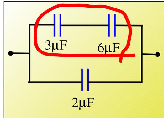
Figura 2: Sección en serie del circuito considerado.
