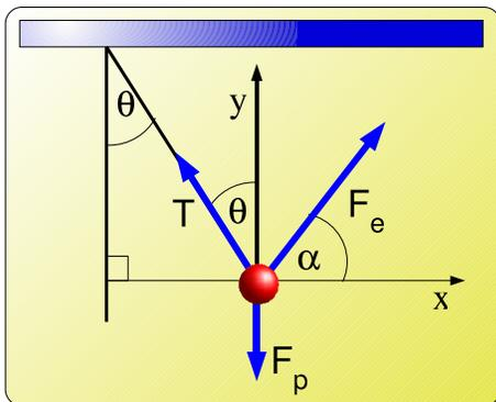
Figura 2: Esfera equilibrada con el peso y la fuerza eléctrica
