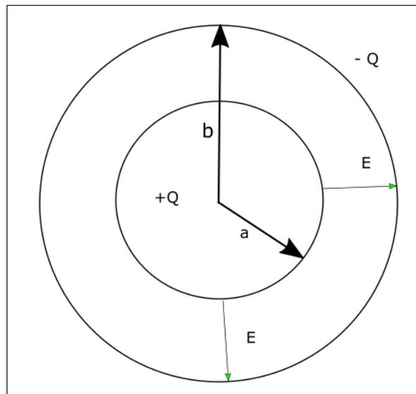
Figura 25: Capacitor esférico.
