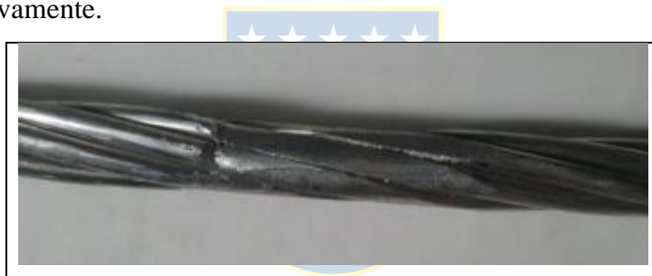
Fig. 4.11. Reducción del área transversal en conductor ACSR.
