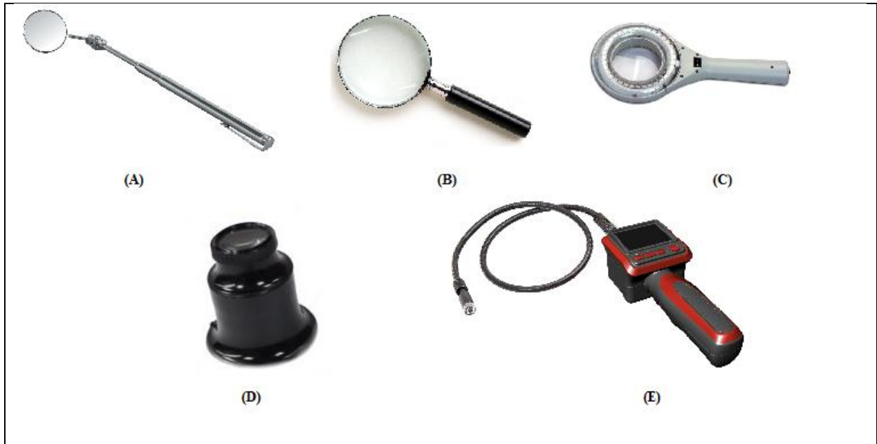
Fig. 3.1 Diferentes apoyos para la realización de la inspección visual.
