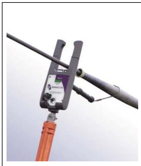
Fig. 5.24. Medición de Resistencia utilizando Ohmstik.
