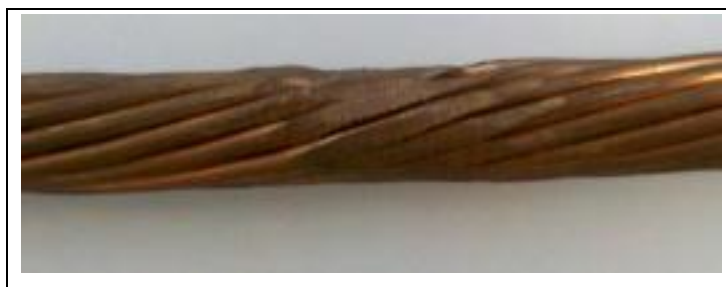
Fig. 4.14 Reducción del área transversal en conductor de Cobre
