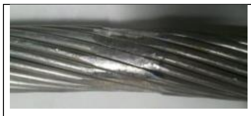
Fig. 4.17. Reducción de área transversal del conductor de aluminio.
