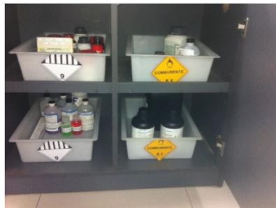
**Figura 1:** Almacenamiento en bandejas de contención de derrames
