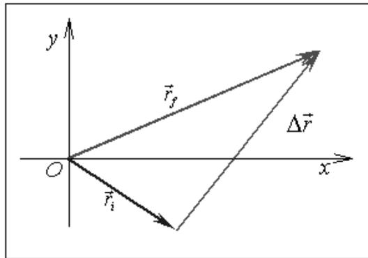
Figura 2.2. Vector desplazamiento en dos dimensiones.
