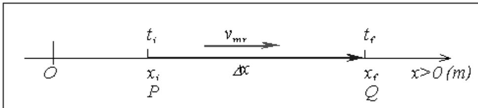
Figura 2.3 Sistema de referencia en una dimensión para definir la velocidad media.
