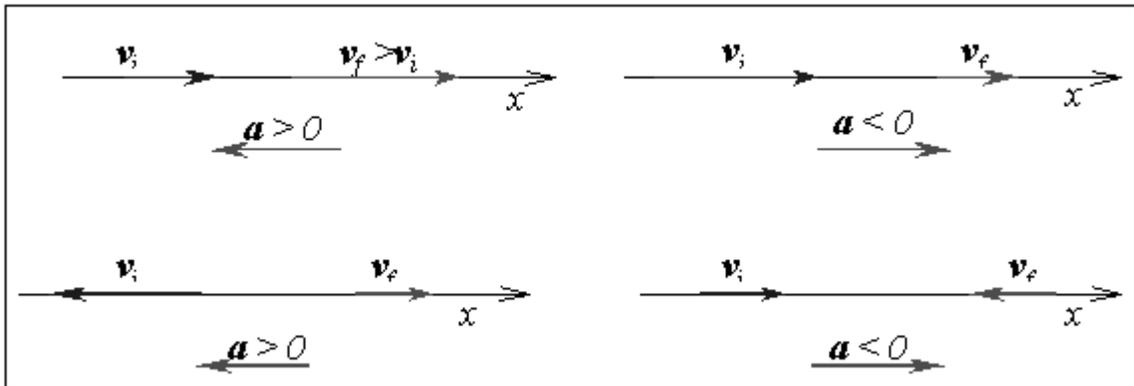
Figura 2.5 Esquema de diferentes sentidos de la aceleración.
