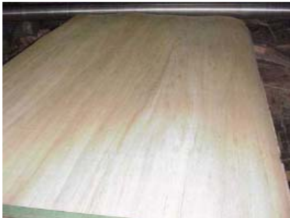
Figura 1.15. Chapa obtenida de árboles de E. nitens podado de 21 años de edad (Infor, 2004b).
