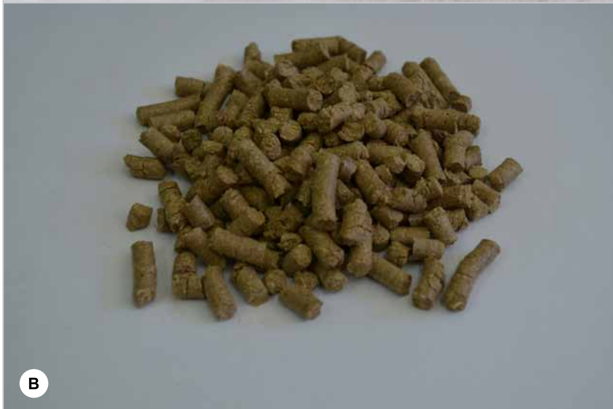
Figura 38. Material de Miscanthus previo a la molienda (A) y pélets de Miscanthus (B).
