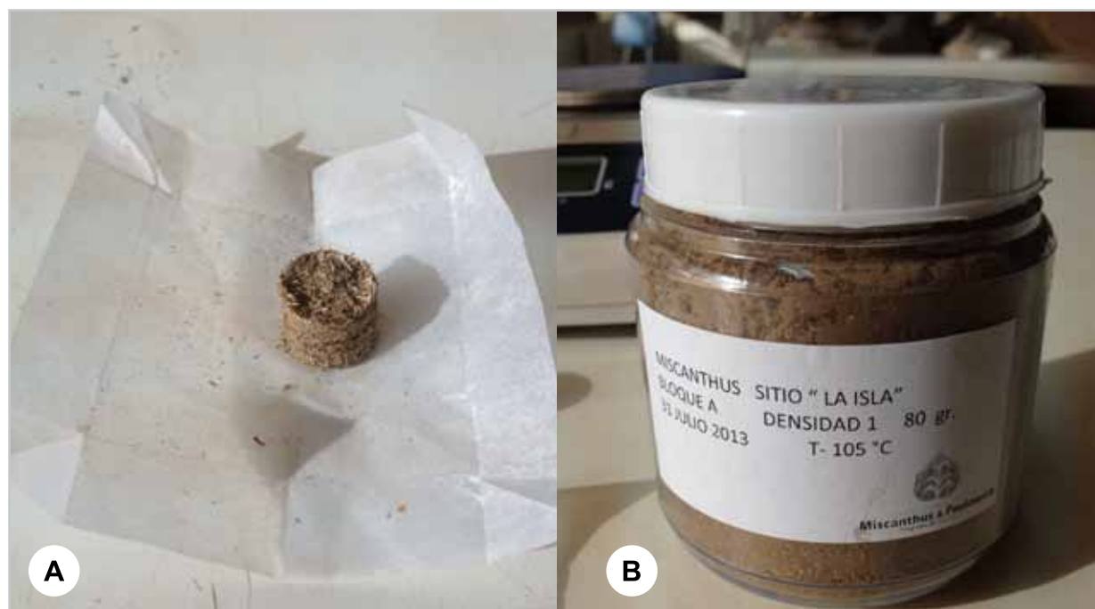
Figura 35. Pélet para determinación de calorimetría (A) y frasco con material de Miscanthus para la formación de pélet (B)
