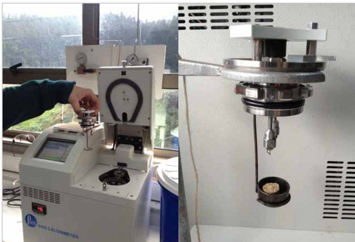
Figura 34. Bomba calorimétrica, modelo PARR 6400, utilizada para la determinación de poder calorífico.
