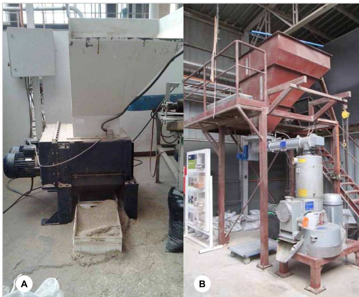
Figura 37. Máquina de molienda (A) y máquina peletizadora (B) (Unidad de Desarrollo Tecnológico (UDT) de la Universidad de Concepción).
